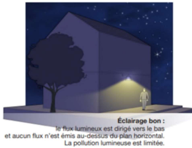
Figure 39. Type d'éclairage du site
